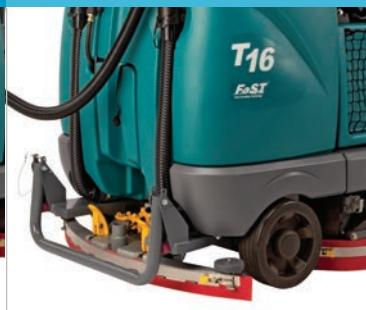
**Proteja a los operarios frente a la caída de objetos con el protector superior y proteja la T16 frente a los daños por contacto con el parachoques delantero para ambientes difíciles.**
