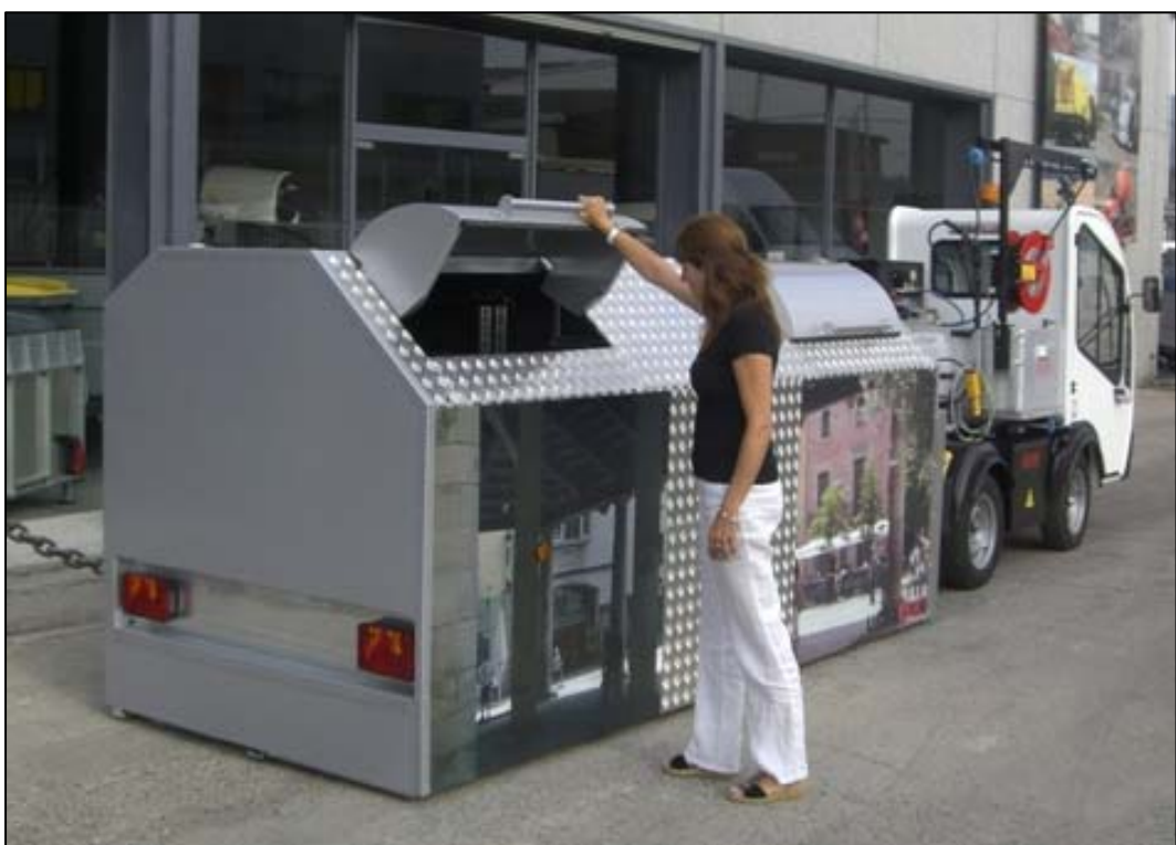
URBACLIC S29F2 semi-remolque para 2 contenedores de 1.100 l., o 4 contenedores de 700 l. o 8 contenedores de 360 l. Los contenedores están escamoteados dentro del semi-remolque. La boca de carga queda prácticamente a la misma altura como si estuvieran en el suelo.
