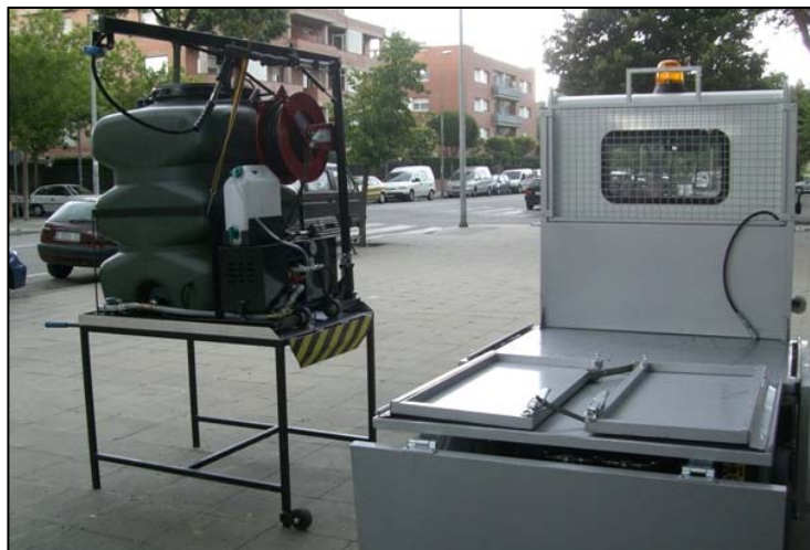
Equipo intercambiable de alta presión con depósito de 530 l.
