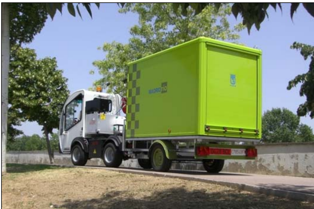
URBACLIC SFRG semi-remolque con furgón cerrado con persianas laterales y trasera. Equipo de agua a alta presión.
