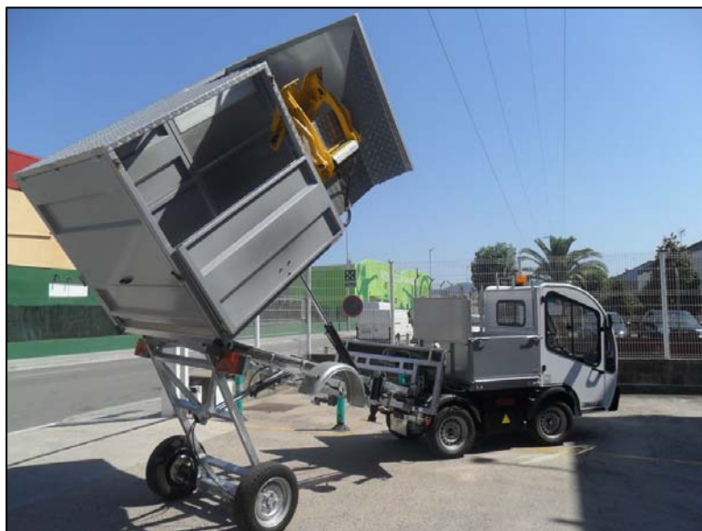
Con semi-remolque para carga lateral de contenedores, bolseo, puerta a puerta etc.
