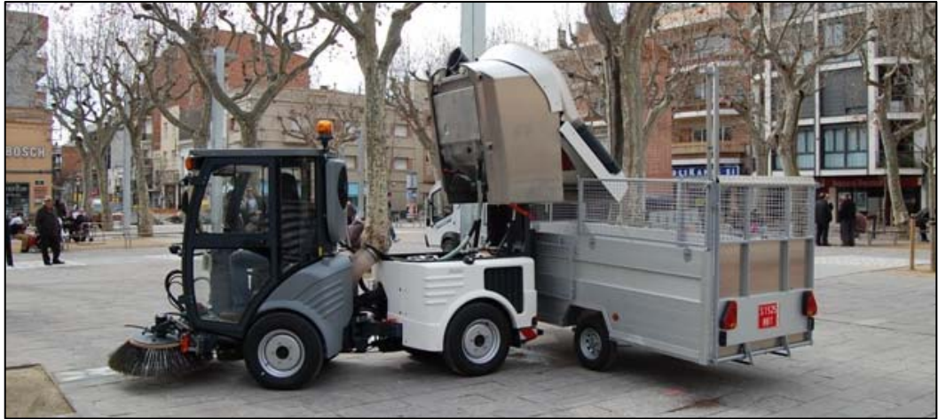
URBACLIC S27 para descarga de barredoras
