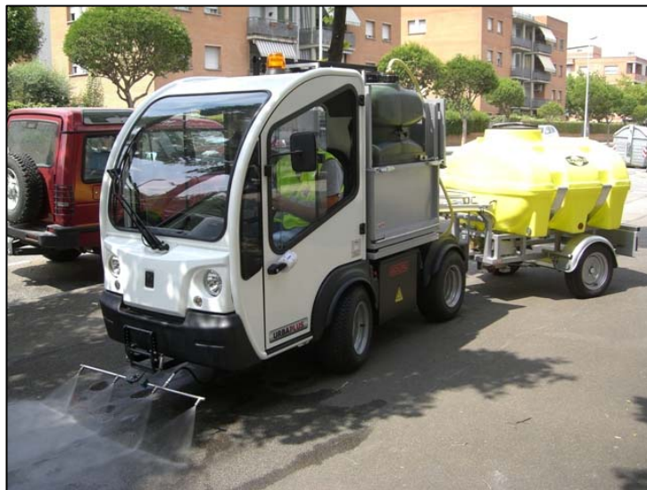
Limpieza con agua a alta presión. Baldeo frontal de calzadas y zonas peatonales. Baldeo manual con pistola y lanza. Riego.
