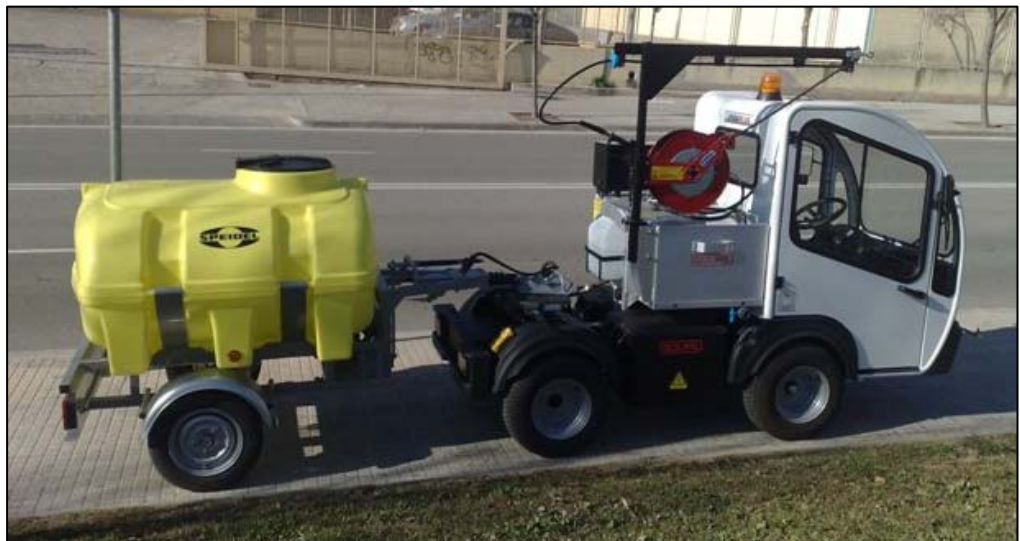
URBACLIC SBR para baldeo a alta presión, baldeo frontal con barra y riego a baja presión en jardinería. Depósito de agua con rompeolas de 1.000 l.
