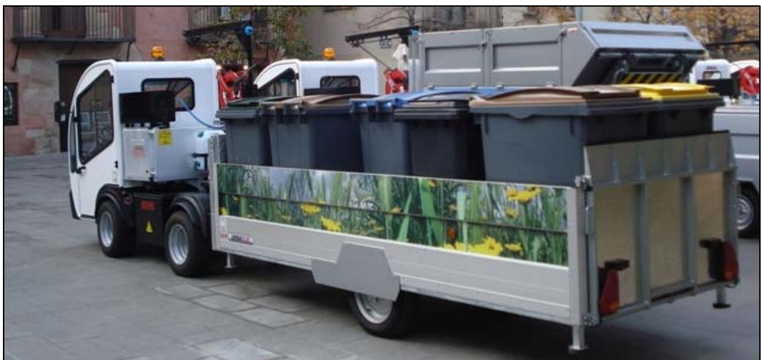
URBACLIC S10 para transporte y posicionamiento de contenedores
