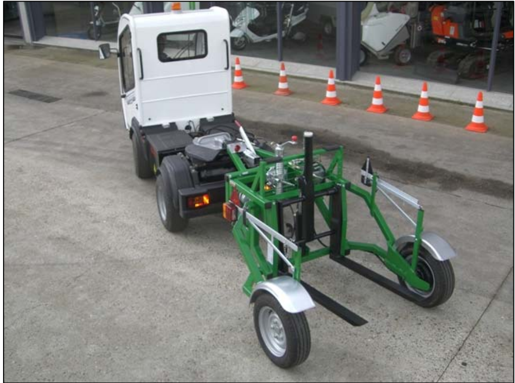
URBACLIC SPL para carga y transporte de todo tipo de palets
