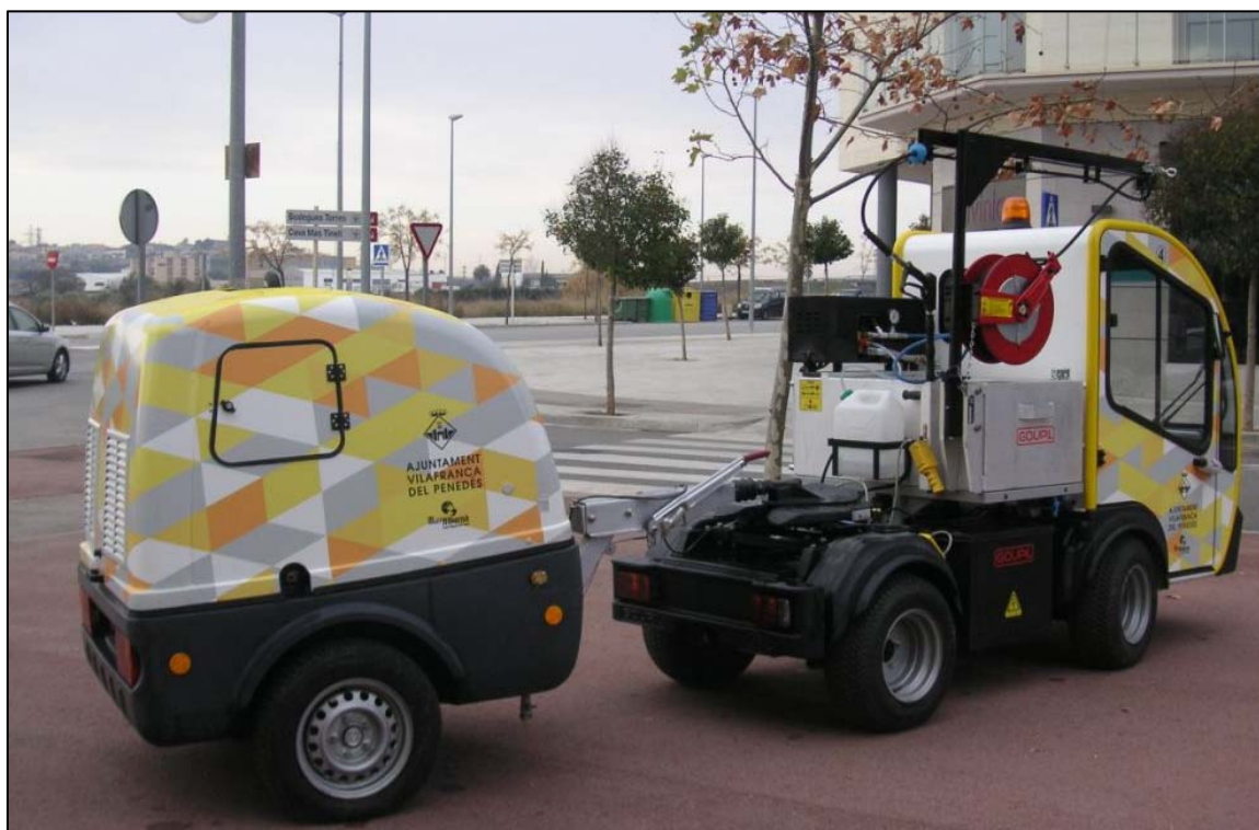
URBACLIC SFA para limpieza y desinfección en profundidad. Alta presión hasta 300 bar. Agua caliente hasta 155° Accionamiento térmico del equipo auxiliar
