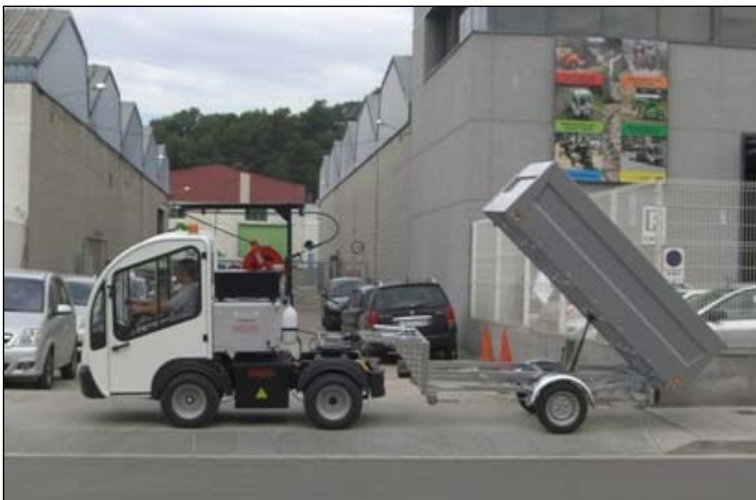
URBACLIC S27H , con volquete electro-hidráulico, para el transporte de residuos, para la descarga de barredoras y para el transporte de áridos.
