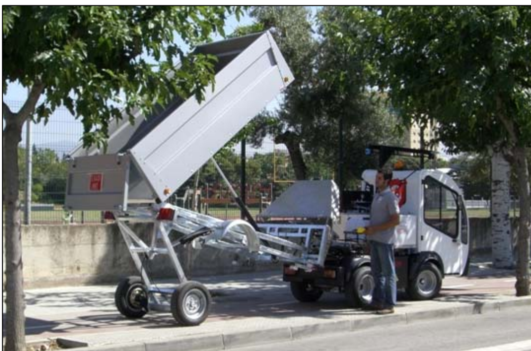
URBACLIC S27A , con volquete electro-hidráulico, para el transporte de residuos, para la descarga de barredoras y para el transporte de áridos. Descarga variable hasta una altura de 1,50 m.
